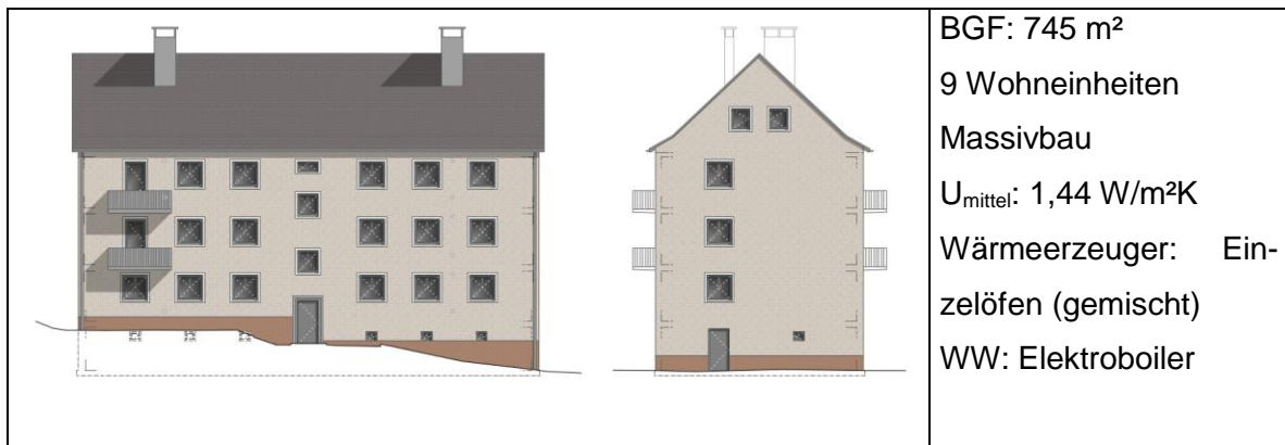
Abbildung 6: Mehrfamilienhaus Bestand; mittlerer U-Wert inkl. Fenster und Wärmebrücken
